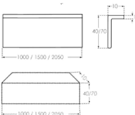
Die Sichtkantenprofile werden vor Ort auf das Maß des SoftBoards angepasst. Zusätzliche Stabilisierung wenn ein bodenebener Einbau aufgrund fehlender Aufbauhöhe nicht möglich ist oder zur Verstärkung an der Einstiegsseite.
