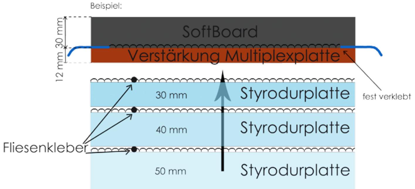
Ein höherer Aufbau kann mit zusätzlichen Styrodurplatten erstellt werden. Diese Platten werden lose mitgeliefert und müssen bei der Montage miteinander verbunden werden (Flexkleber).
