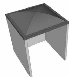
Soffitto a padiglione Toit en pavillon Cloister vault ceiling
